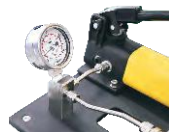
图7 增压到表1所示设定压力
